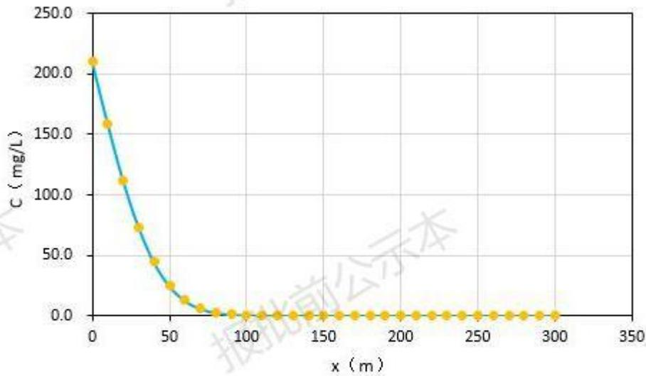
图 5.1-4 连续泄漏 1000 天镍污染扩散距离图
