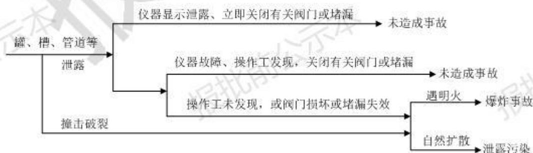
图 6.5-2 储罐、管道系统事故发生示意图
