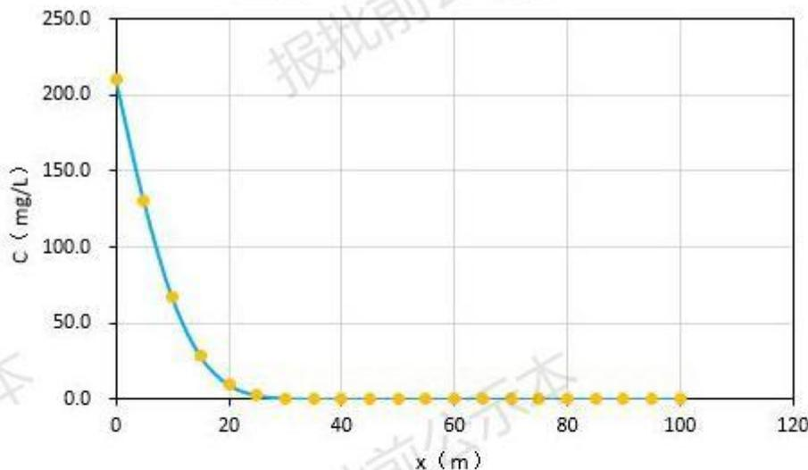
图 5.1-3 连续泄漏 100 天镍污染扩散距离图
